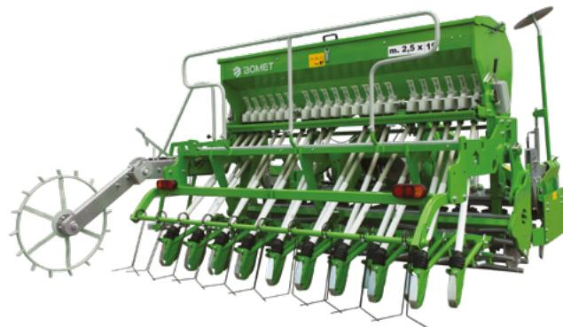
Les semoirs universels Scorpius peuvent être équipés de socs houes, ou de coutres mono-disques, ou de coutres double disques.
