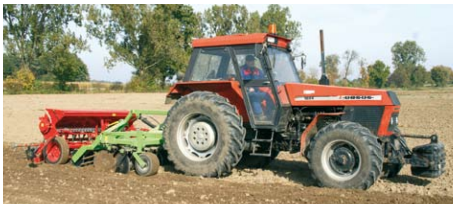
Przód ciągnika można dociążyć obciążnikiem balastowym, ale lepiej zastosować dodatkowe narzędzie.
