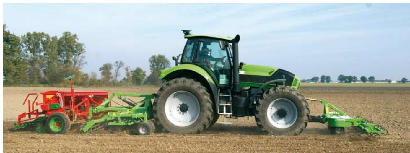
Ciągnik z maszynami zawieszonymi z przodu i z tyłu jest równomiernie obciążony podczas pracy i transportu.
