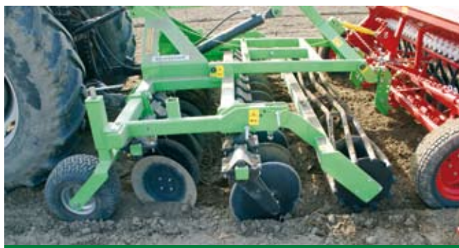
Agregat 3-metrowy wyposażony w pojedyncze koła przednie, 2-rzędową bronę talerzową i wał.
