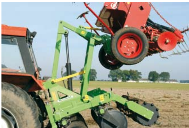
Uniesiony sprzęg blokowany jest łącznikiem.
