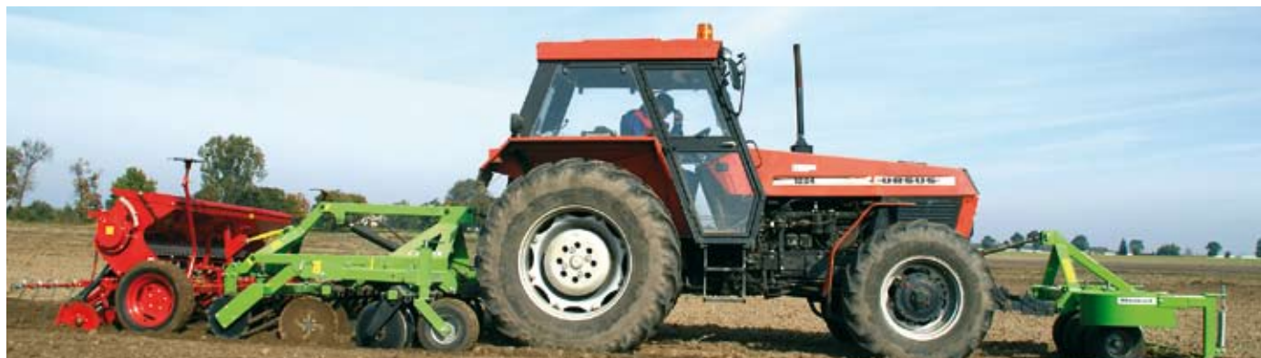
Ciągnik o mocy 117 KM dobrze radzi sobie z 3-metrowym zestawem złożonym z narzędzia przedniego i agregatu uprawowo-siewnego z broną talerzową.
