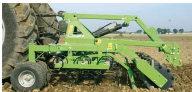
Agregat 4-metrowy wyposażony w podwójne koła przednie, 3-rzędowy kultywator, włókę i wał.
