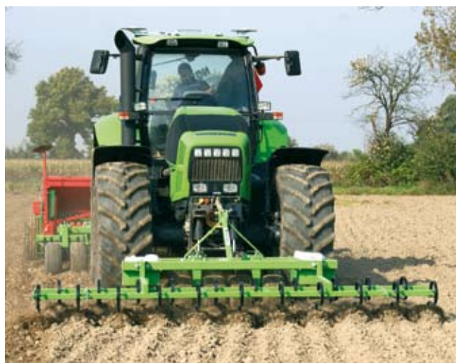
Kultywator dobrze kruszy i wyrównuje glebę przed ciągnikiem.
